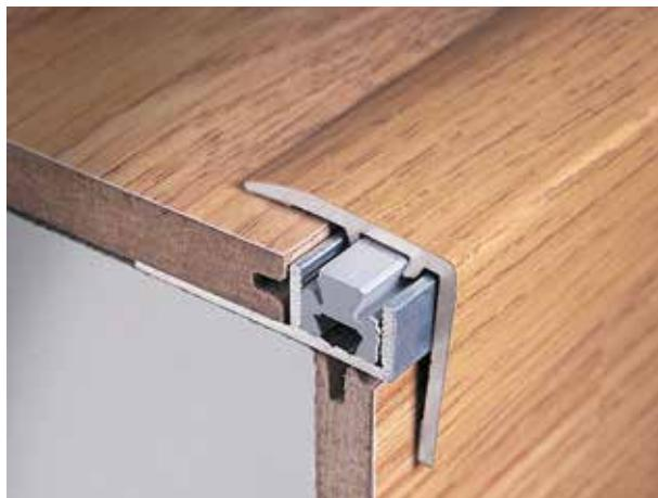
Nez de marche pour terminer proprement le coin de la marche en utilisant le même matériau que le revêtement. Il rend la marche en même temps plus visible et en améliore la durée. Il protège de façon efficace les chants des contremarches et gîrons contre les ébréchures et il en masque les éventuels défauts de coupe et de jonction.
